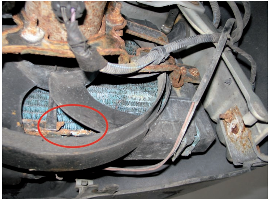
Abb. 10: abgerostete Verstrebung am Kühler
