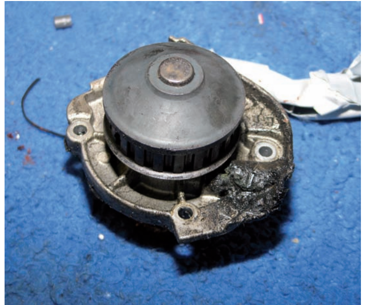
Abb. 8: Wasserpumpe ausgebaut, keine Wasserablaufspuren
